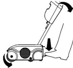
4. Wenn Sie den Behälter wieder in die vertikale Stellung setzen (Ruhestellung), schaltet sich das Gerät automatisch ab.
